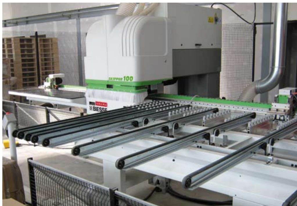
Sterowane cyfrowo centrum wiertarskie Skipper 100 L Biesse jest dziesięć razy wydajniejsze niż tradycyjne wiertarki wielowrzecionowe.
